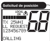
La solicitud de posición entrante hace sonar la alarma de **solicitud de posición** y en la pantalla aparece el nombre de la estación solicitante. Su radio responderá automáticamente. Transmitirá su posición, si tiene un **GPS** conectado a su aparato de radio, o bien NO POS. DATA (no hay datos de posición) si no se tiene un **GPS** conectado.
